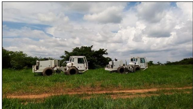
Camiones vibradores (Vibroseis) utilizados como fuente de energía de ondas -P y -S.
