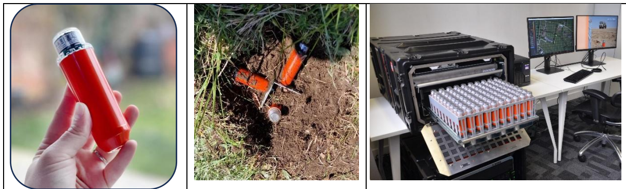
Figura 15. De izquierda a derecha: el nodo autónomo de sensor único de Stryde, el arreglo 3C, el sistema de carga y extracción de datos Nimble.
